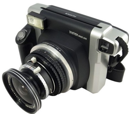
Obr. 35 – Fotoaparát Instax Wide 300 s konverzí fotoaparátu s kvalitnější skleněnou optikou.
